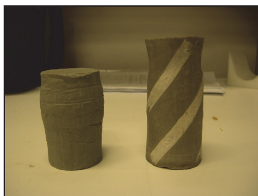
Figur 9 I figuren visas ett prov som har utsatts för aktiv belastning (axiell hoptryckning, det vänstra) och ett prov för passiv belastning (axiell expansion, det högra). Bilden visar lerprov som har torkats ut efter utfört försök. Notera "tunnformen" respektive "timglasformen" som uppstår vid skjuvning till större deformationer
